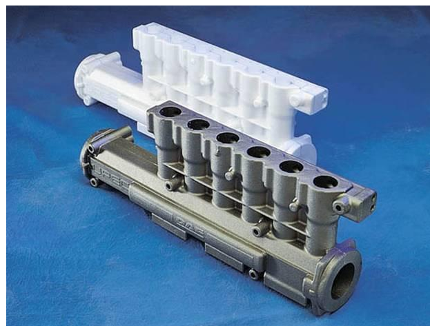
Figuur 12: dieseloliepomp 6 cilinder dieselmotor m.b.v. verloren-schuim-model van Lovink Aluminium BV
