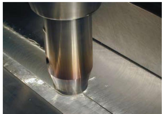
Figuur 23: friction stir welding van 2 platen
