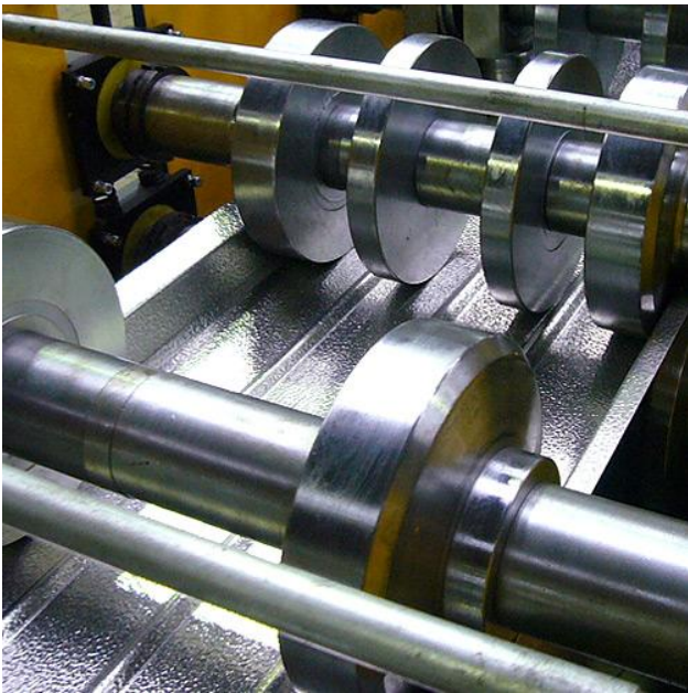
Figuur 36: rolvormen van aluminium
